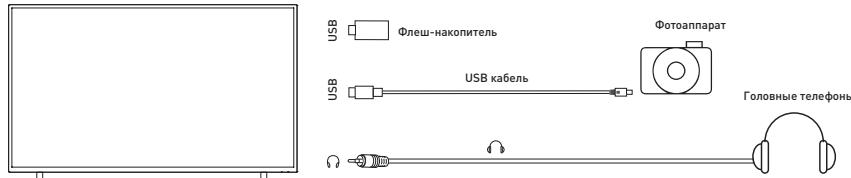
Разъем для подключения USB-устройства телевизора становится активным только в режиме Медиа
