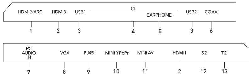
1. **HDMI/ARC** Вход для HDMI, интерфейс для подачи видео и аудиосигнала высокой четкости
