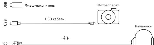
Разъем для подключения USB-устройств на корпусе телевизора становится активным только в режиме USB.
