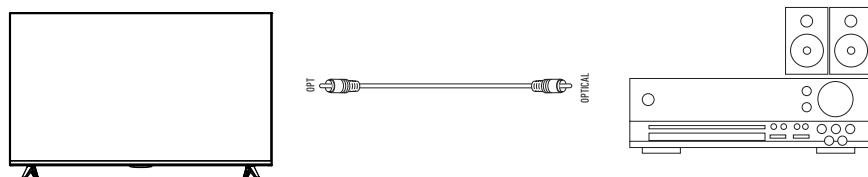
Только для ЦТВ или источника сигнала **HDMI**. Подключите оптический вход внешней аудиосистемы к соответствующему выходу телевизора.
