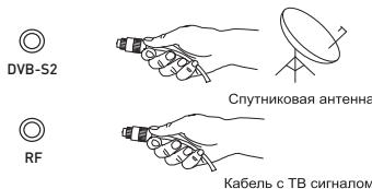
Вставьте штекер антеннного кабеля в гнездо антенны, расположенное на задней стенке телевизора. Для обеспечения качественного приема телевизионного сигнала рекомендуется использовать коллективную antennу. Для лучшего приема эфирного вещания используйте коаксиальный радиочастотный кабель с волновым сопротивлением 75 Ом (в комплект поставки не входит). Антенный кабель не должен быть перемотан со шнуром питания!
