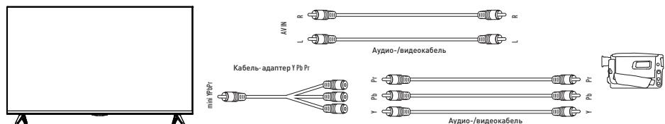
Подключите видеокамеру к телевизору, используя кабель-адаптер **YPbPr** (для видео) и аудиокабель **2xRCA** «тюльпан» [кабель-адаптер **mini YPbPr 3,5мм – YPbPr** и аудиокабель **2xRCA** «тюльпан» в комплект поставки не входят].
