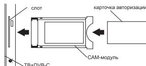
1. Осторожно вставьте **CAM-модуль** в слот **COMMON INTERFACE**.
