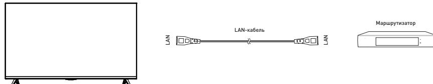
Подключите LAN-кабель со штекером RJ-45 к разъему **LAN** на задней стороне телевизора. Это необходимо для работы SMART-режима ТВ в режиме проводной интернет-сети.
