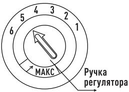
Если на посуде образуются пятна, и посуда плохо высушивается, увеличьте расход ополаскивателя. Для этого нужно снять крышку дозатора и установить ручку регулятора на позицию «5». Если после этого посуда по-прежнему плохо высушивается, или на ней образуются пятна, установите ручку регулятора на следующую позицию. Продолжайте это до тех пор, пока на тарелках перестанут образовываться пятна.
